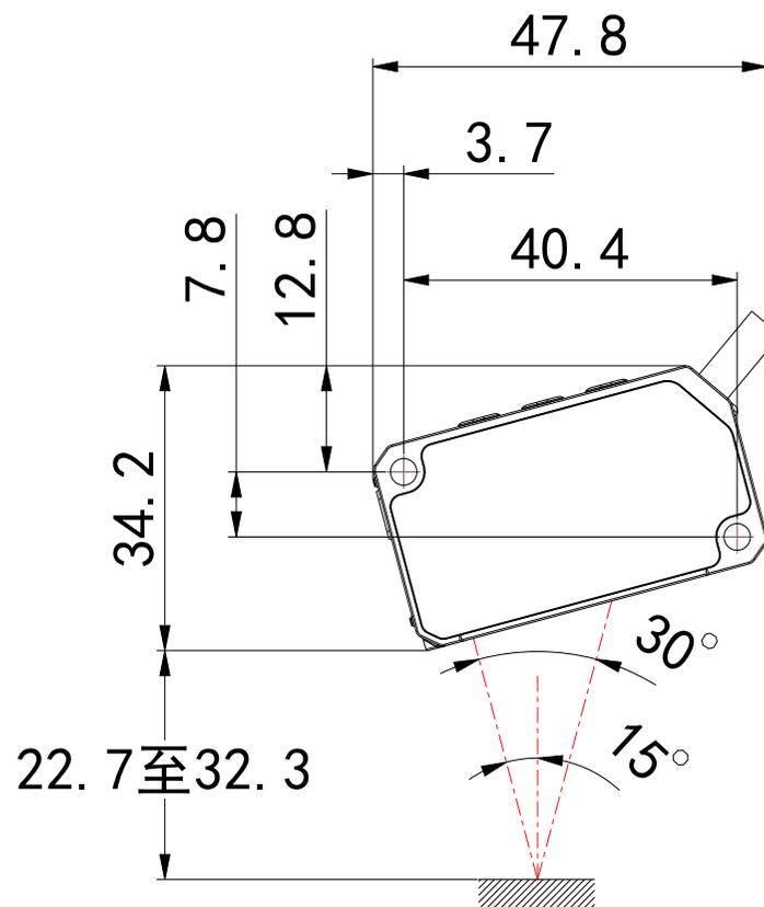
镜面反射型安装
